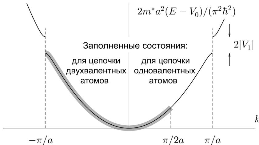
**Рис. 15.7.** Спектр электронных состояний в одномерной цепочке атомов в модели слабой связи. Толстые серые линии указывают на заполненные состояния в пределах первой зоны Бриллюэна для цепочки двухвалентных атомов (левая часть рисунка) и одновалентных атомов (правая часть рисунка)
